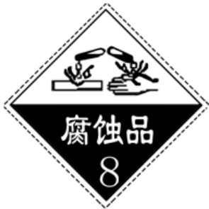
图 2-12 腐蚀性警示标识
