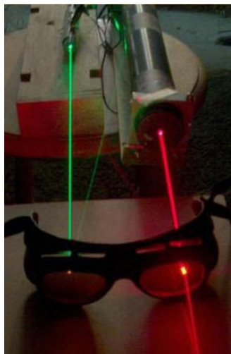
图 8-3 特定的眼镜只能防护特定激光演示图
