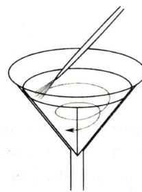
图 4.5 在滤纸上洗涤沉淀
