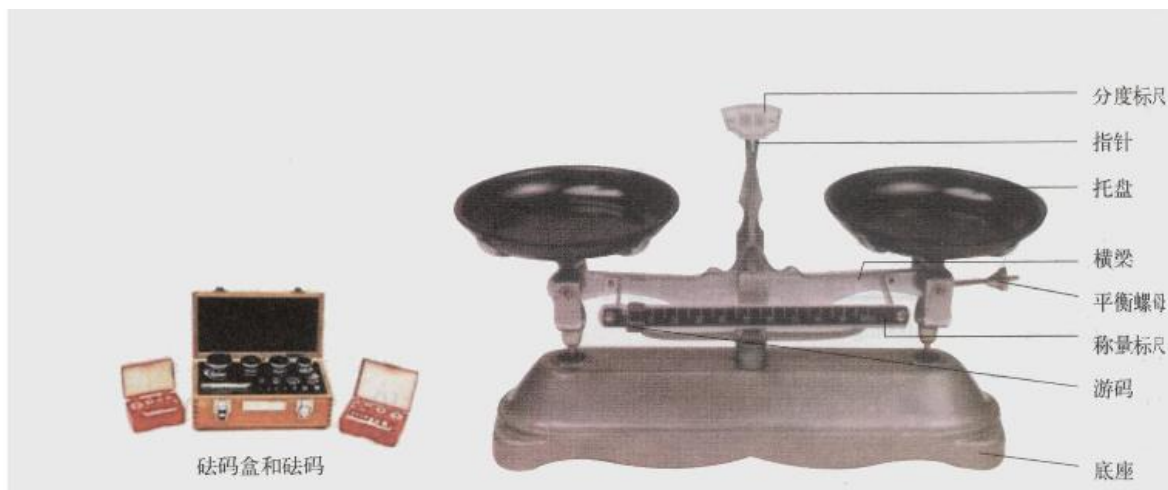
图 6.1 台秤的构造
