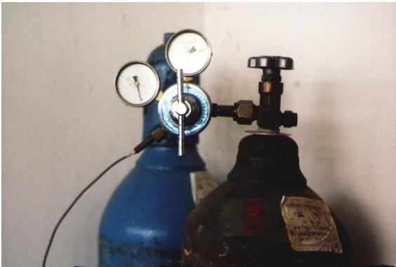
图 2-2-7 安装在气体钢瓶上的氧气减压阀示意图 图 2-2-8 氧气减压阀工作原理示意图
